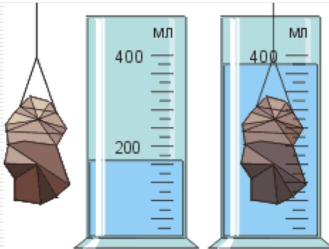
На тело, погруженное в жидкость, действует выталкивающая сила, равная весу жидкости, вытесненной телом.
