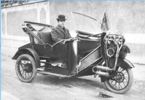
**Phaeton с двигателем воздушного охлаждения, вентиляторами пропеллерного типа и одним передним ведущим колесом, 1910 г.**
