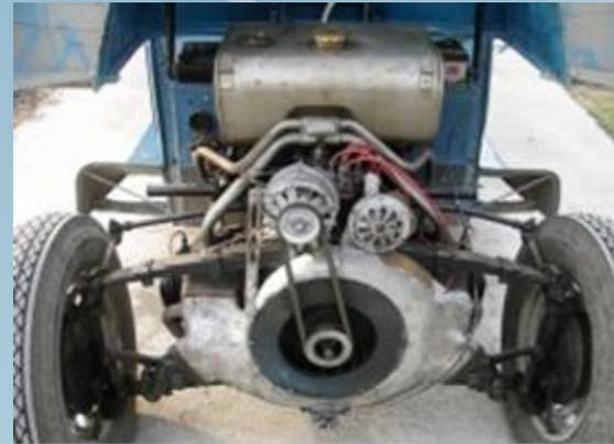
**Двухцилиндровый оппозитный мотор Tatra 57 воздушного охлаждения с центробежным вентилятором. Особый интерес представляет схема воздушного охлаждения моторов гоночных машин Tatra 50-х годов.**
